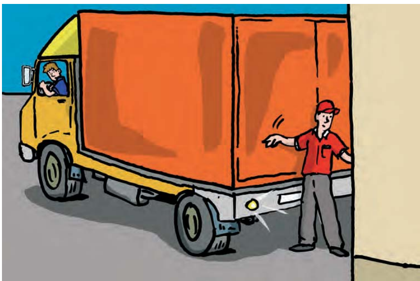
NO DIRIGIR MANIOBRA ATRAQUE DE LOS VEHÍCULOS QUE LLEGAN AL MUELLE DE CARGA/DESCARGA
